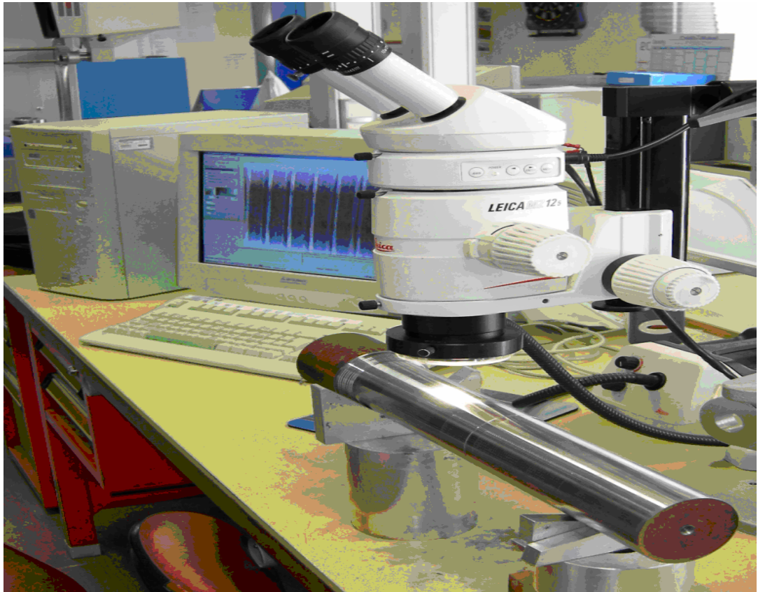
Figure IV.16 Analyse des sillons sur tribomètre radial
