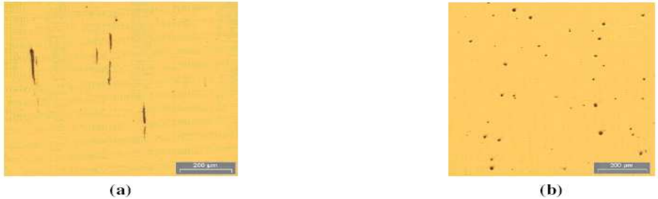
Figure I.2 : Inclusions du 42CrMo4 après laminage pour deux nuances : a) standard, b) à usinabilité améliorée par traitement calcium V2000 [3]
